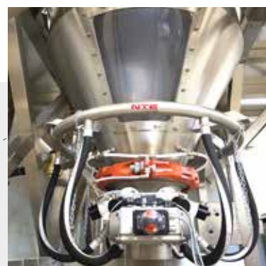
Blender M244 Sistema di fluidificazione e miscelazione
