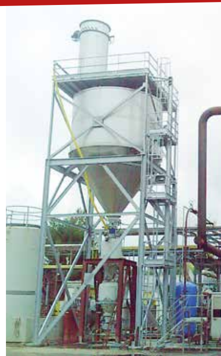
Sistema di dosaggio a perdita di peso & trasporto in fase densa
