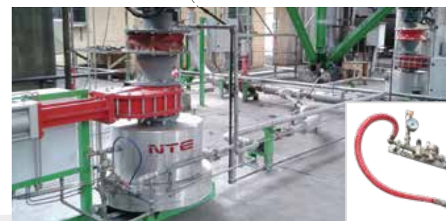
Minijet Fly Ash con valvola a doppio disco ceramico
