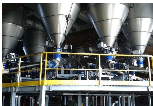
COCLEE GEMELLE DI DOSAGGIO E PESATURA
